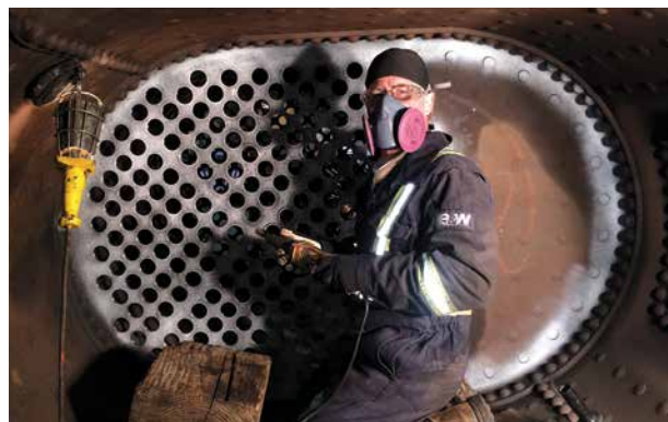
BILL ROGERS (FOTO SUPERIOR), BARRY DOBRENSKY (FOTO DE ABAJO A LA DERECHA), Y MIKE ROXBURGH (FOTO INFERIOR, SENTADO A LA IZQUIERDA) trabajan para reentubar un burro de vapor propiedad de Western Vancouver Island Industrial Heritage Society en Port Alberni.
